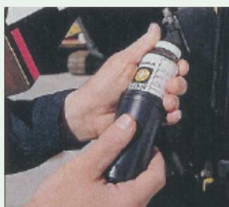
**E** Sortez le tube du compartiment. Retirez la bouteille de la pompe aspirante et fermez-la hermétiquement. Ranger ensuite la bouteille dans le tube d'envoi après avoir rempli rigoureusement l'étiquette.
