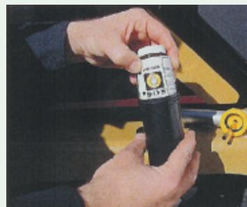
**D** Retirez la sonde du robinet et fermez hermétiquement la bouteille d'échantillonnage. Placez ensuite la bouteille dans le tube d'envoi, après avoir rempli rigoureusement l'étiquette.
