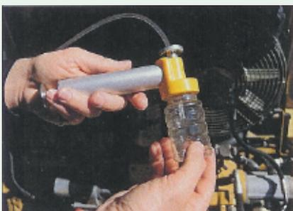
**C** Installez un nouveau flacon d'échantillonnage sur la pompe aspirante et plongez l'extrémité du tube dans l'huile. Assurez-vous que le tube ne touche pas le fond du compartiment.
