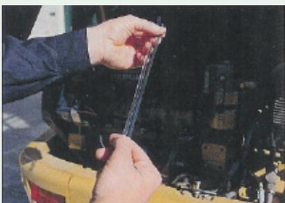
**A** Coupez le moteur. Mesurez et coupez un tube d'une longueur égale à celle de la jauge. S'il n'y a pas de jauge dans le compartiment dans lequel vous voulez prélever un échantillon, coupez le tube de façon qu'il atteigne la moitié de la profondeur du réservoir d'huile.
