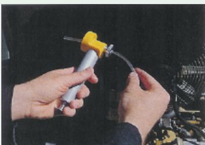
**B** Introduisez le tube à l'intérieur de la tête de la pompe aspirante et serrez l'écrou. Le tube devrait dépasser de 4cm (1 pouce) la base de la tête de la pompe aspirante.
